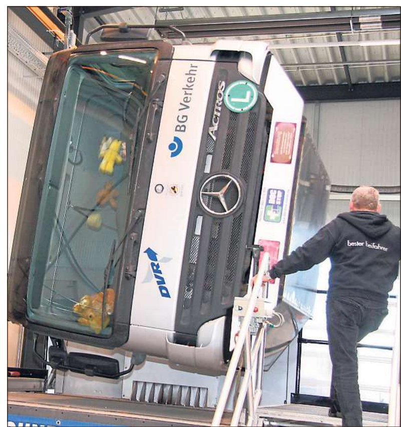
Kuscheltiere fliegen im Innern der Fahrerkabine umher, als sich diese auf die Seite dreht. Sie verdeutlichen, welche Kräfte bei einem Unfall wirken. Verkehrsmoderator Jürgen Schöbel steuert den Überschlagssimulator.
